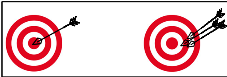
Fig. 2.2 Diferencia entre exactitud (a la izquierda) y precisión (a la derecha)
