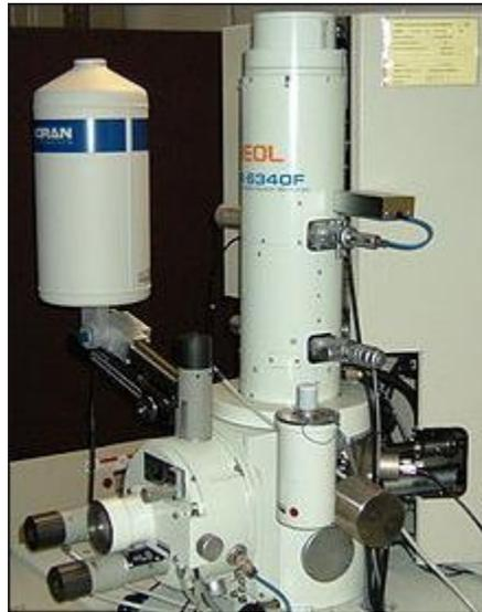
Fig. 2. 24 Microscopio Electrónico de Barrido
