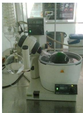
Fig. 3. 3 Obtención de extracto en el roto evaporador
