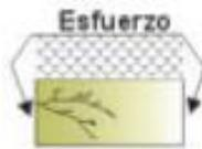
Fig. 2. 11 Corrosión Bajo Tensión
