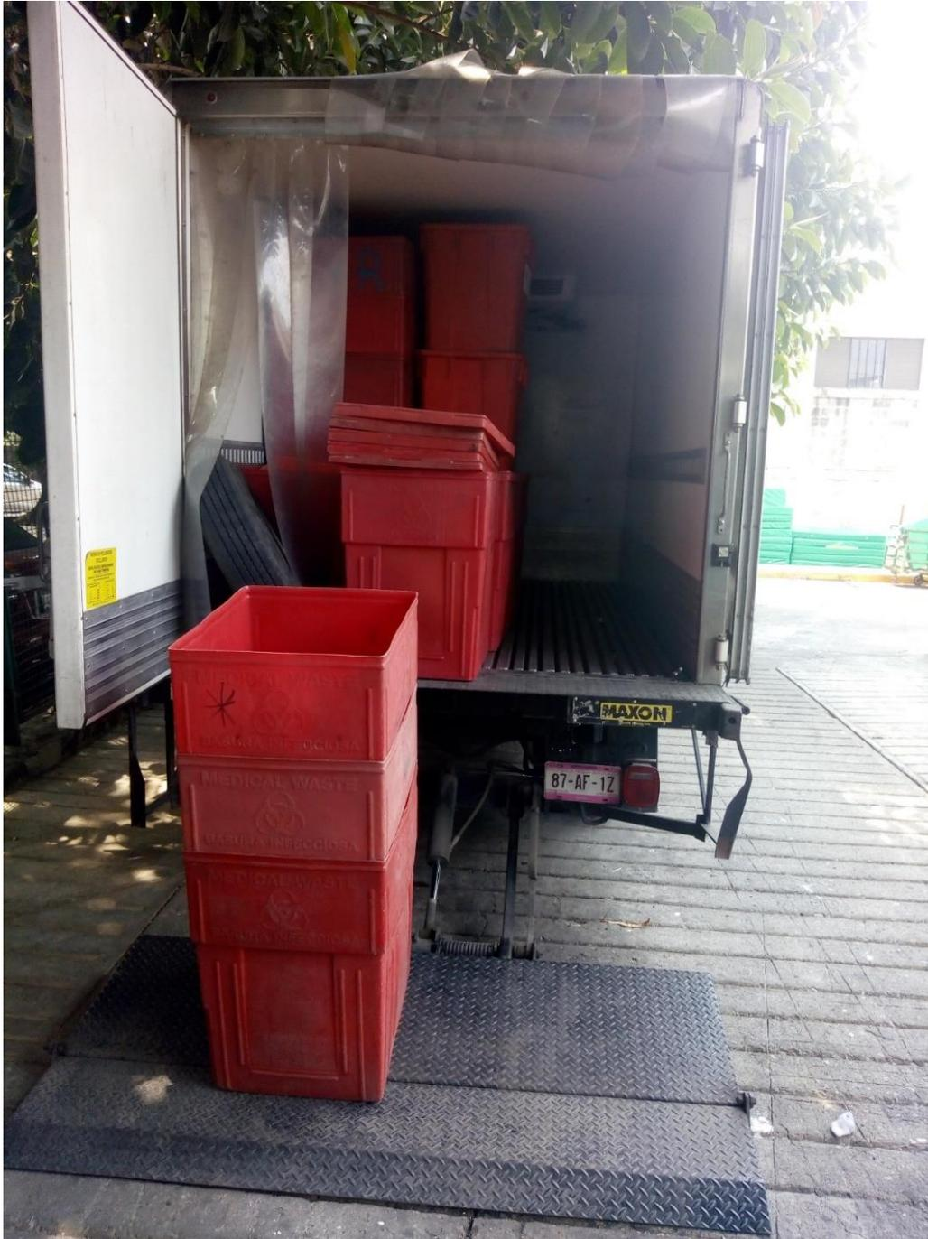
*Figura 20. Caja y sistema de carga del vehículo destinado al transporte de RPBI's.*
