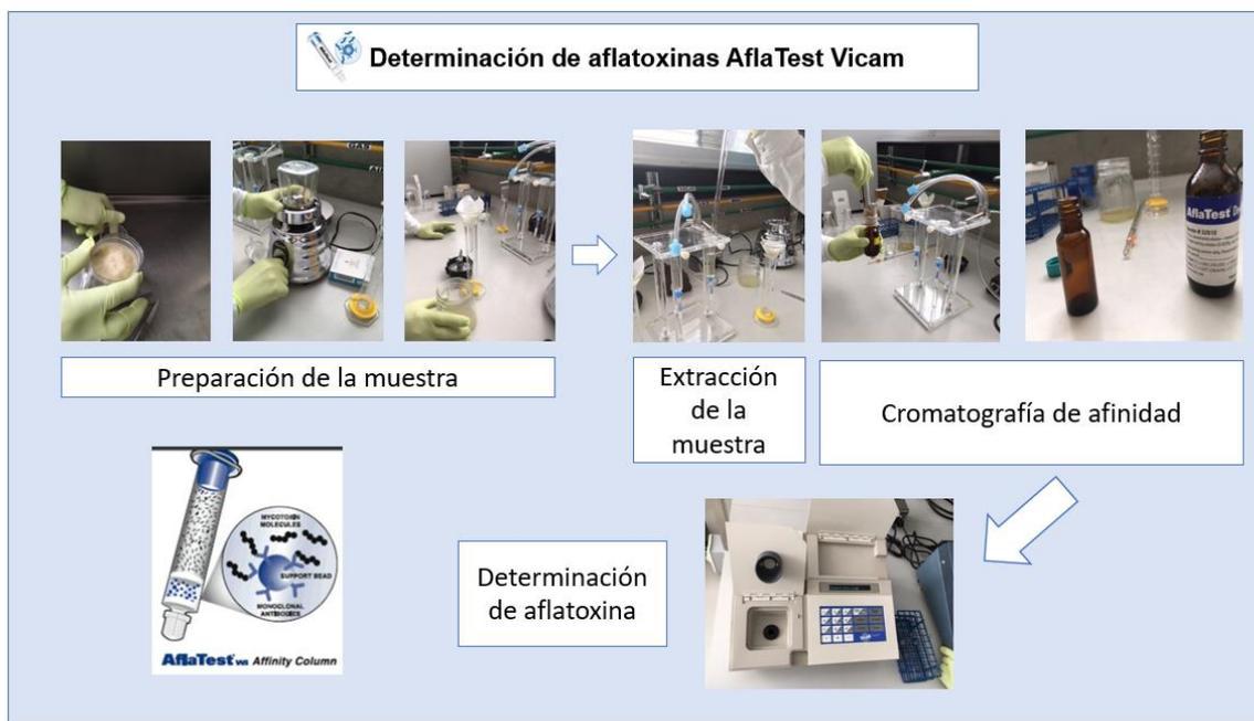
Figura 21. Determinación de aflatoxinas totales producidas por *A. flavus* bajo diferentes tratamientos de quitosano y propóleo.
