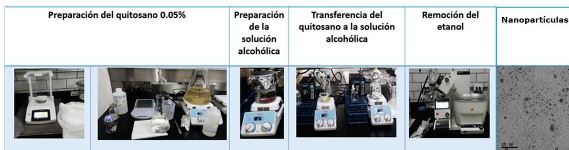
Figura 14. Preparación de las nanopartículas de quitosano y propóleo por el método de precipitación.
