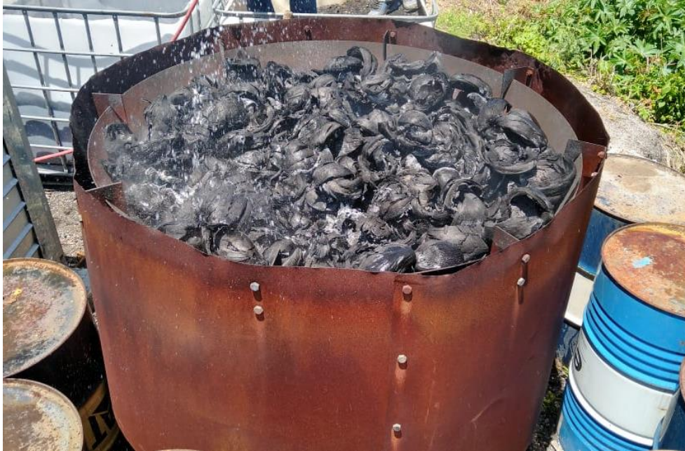
Figura 5. Producción de biocarbón instalaciones de la planta de gasificación de la Universidad Nacional Autónoma de México, SAGARPA
