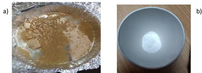
Figura 10. a) Cascarilla antes de calcinación, b) SiO<sub>2</sub> obtenida.
