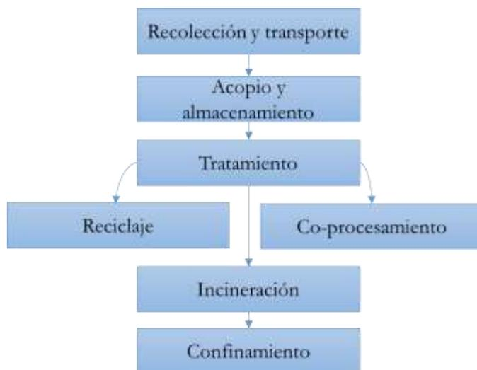
**Figura 6. Diferentes fases del manejo de residuos peligrosos.**
