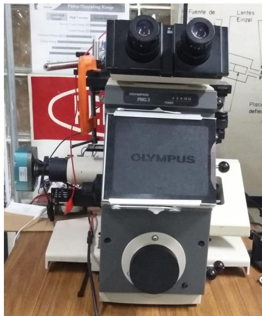
Figura 3.16. Microscopio óptico Olympus PMG3.
