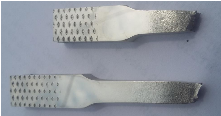
Figura 4.4. Probeta sometida a pulido espejo.
