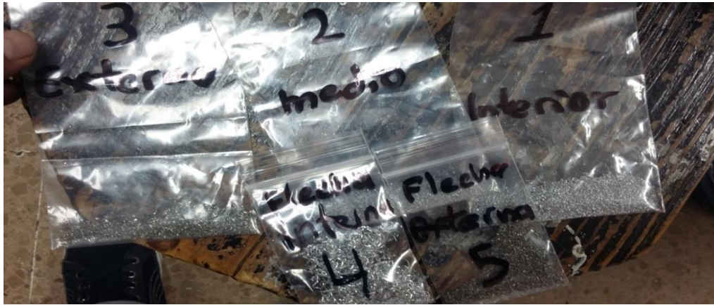
Figura 3.6. Rebabas de los diferentes materiales almacenados en bolsas para su posterior análisis químico por absorción atómica.
