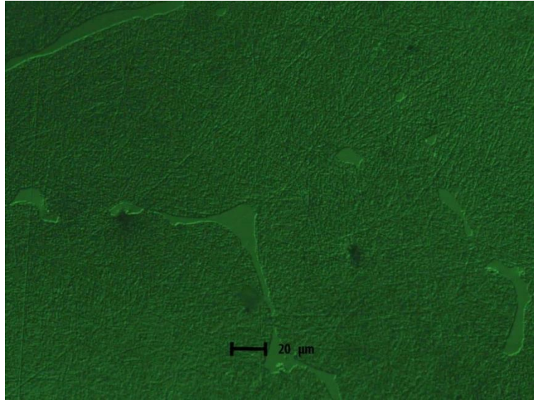
Figura 4.53. Visualización con ataque químico. 250X.
