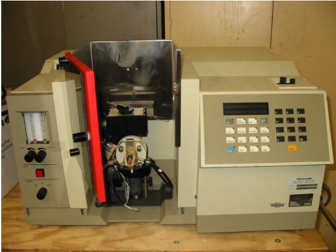
Figura 3.9. Fotografía de equipo de espectroscopia atómica.
