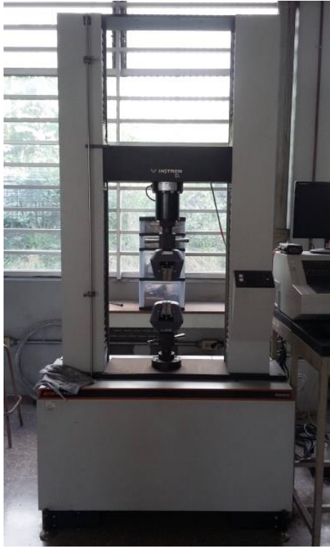
Figura 3.11. Vista frontal de equipo de tensión
