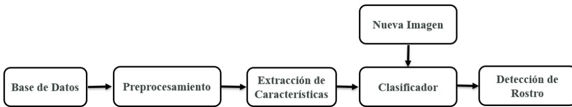
Figura 2.1: Metodología para la detección de rostros basado en el enfoque geométrico)
