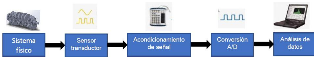
Figura 35. Sistema básico de adquisición de datos. Fuente: Del autor.
