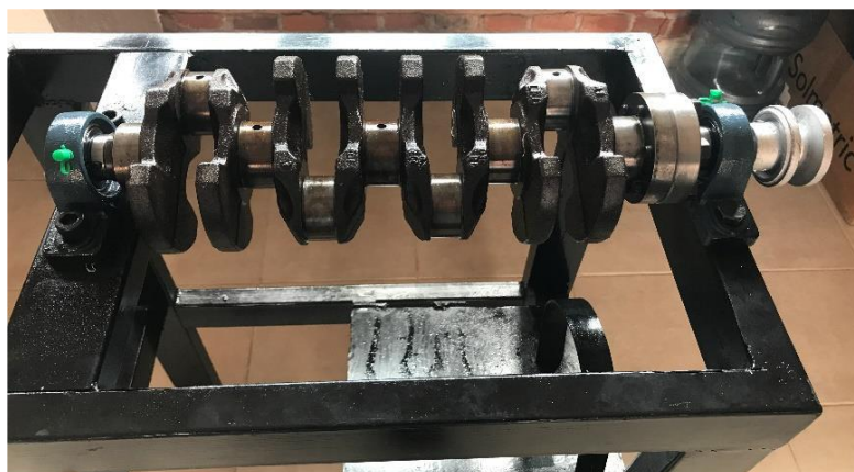
Figura 25. Montaje del cigüeñal. Del autor.
