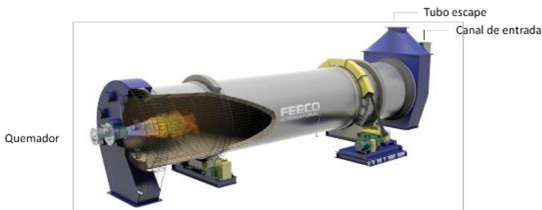
Figura V-2. Horno rotatorio para la obtención de Clinker.
