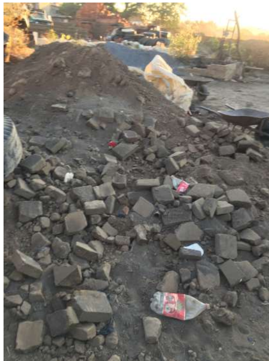
Fotografía 13. Almacenamiento de ladrillos defectuosos secos
