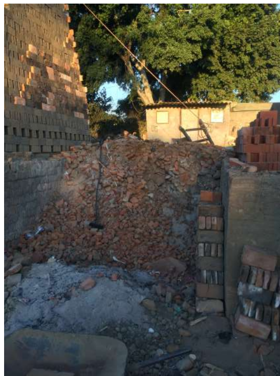
Fotografía 14. Almacenamiento de ladrillos defectuosos horneados
