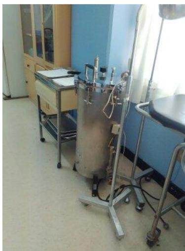
Figura 4. Autoclave para el tratamiento interno de los RPBI del Centro Médico Universitario
