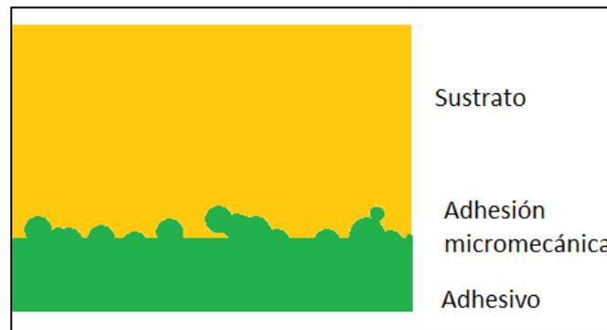
**Figura 2.5.3. Mecanismo de adhesión micromecánica**
