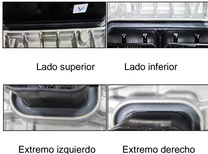
**Figura 4.14.2. Inspección visual muestra tratada por choques térmicos**
