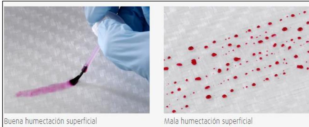
**Figura 2.9.2. Prueba de Dinas o Tinta (Plasmatreat GmbH, 2018)**
