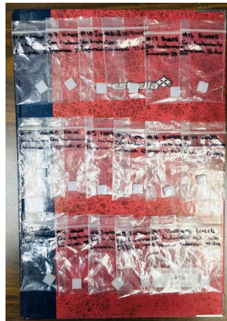
Fig. 12. 18 Probetas de UHMWPE inmersas en fluidos corporales simulados. 9 de ellas fueron con tratamiento de plasma (2da etapa).
