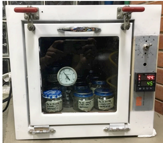
Fig. 23. Horno para pruebas de inmersión estática en UHMWPE a una temperatura de T = 37^{\circ} \text{C} .
