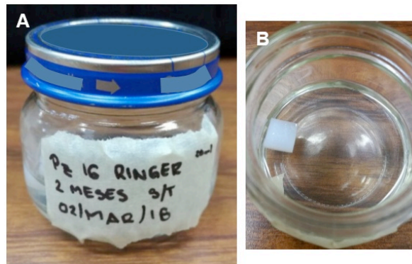
Fig. 33. UHMWPE inmersa en solución Ringer por 63 días a T = 37^{\circ} C .
