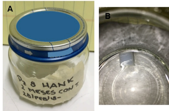
Fig. 27. UHMWPE con tratamiento de plasma de oxígeno, inmersa en solución Hank por 63 días a T = 37^{\circ} C .
