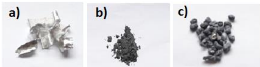
Figura 2.6. a), b) y c) . Viruta de Mg, polvos partículas de zinc y calcio.
