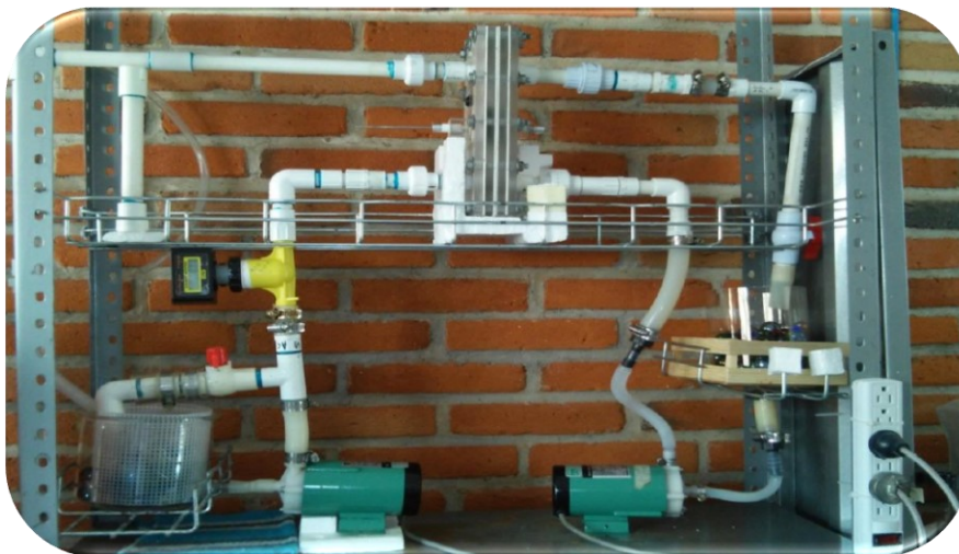
Fig. 4.3: Reactor de placas paralelas con flujo continuo.
