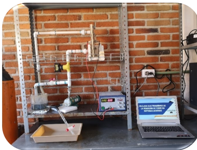
Fig. 3.21: Celda de placas paralelas.
