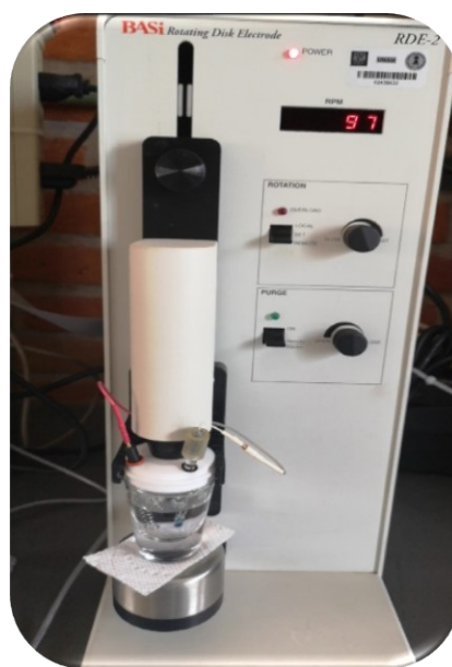
Fig. 3.18: Electrodo de disco rotatorio (RDE).
