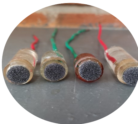
Fig. 3.1: Elaboración de electrodos de trabajo con RVC.
