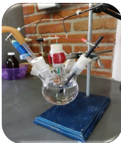
Fig. 3.7: Celda electroquímica usada en electropolimerización de anilina.
