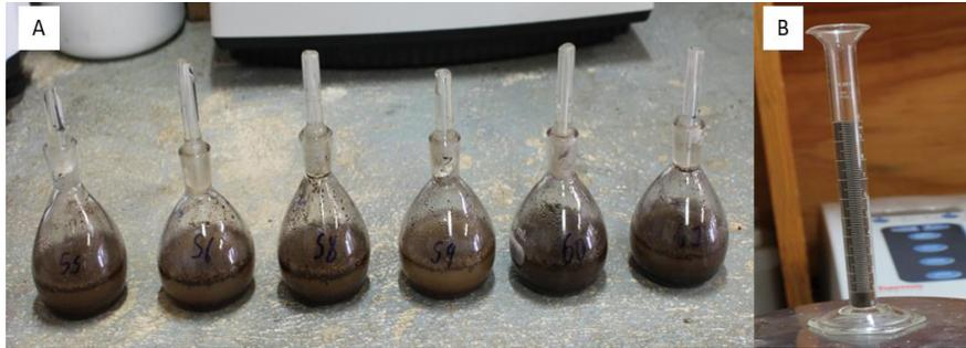
**Figura 7.** Densidad real y aparente. A. Proceso para densidad real, suelo más agua reposando en los picnómetros por 30 minutos antes de llenar con agua destilada. B. Determinación de la densidad aparente, llenado de la probeta de 10 ml con suelo para ser pesado.
