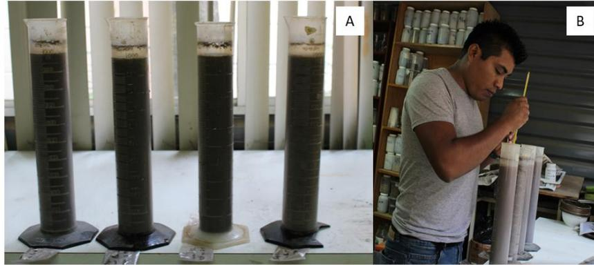
**Figura 8.** Determinación de texturas del suelo. A. Reposo de las muestras una vez obtenida la primera lectura. B. Obtención de la segunda lectura dos horas después de reposar.
