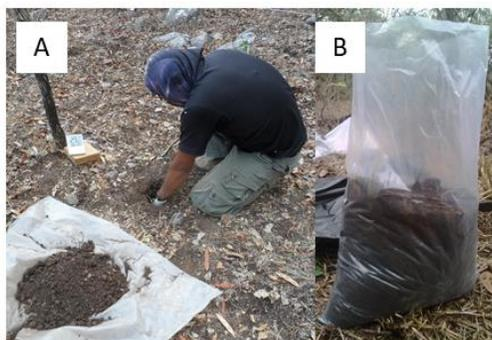
**Figura 6.** Extracción de muestra de suelo. A. Obtención de muestra de suelo compuesta de 5 a 20 cm de profundidad de la zona 2 caliza. B. Transporte de 2 kg de muestra en bolsas para posteriormente ponerlas a secar.
