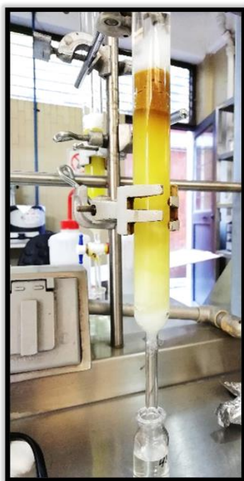
Figura 13. Columna empacada con sílice gel fase normal y muestra adsorbida.
