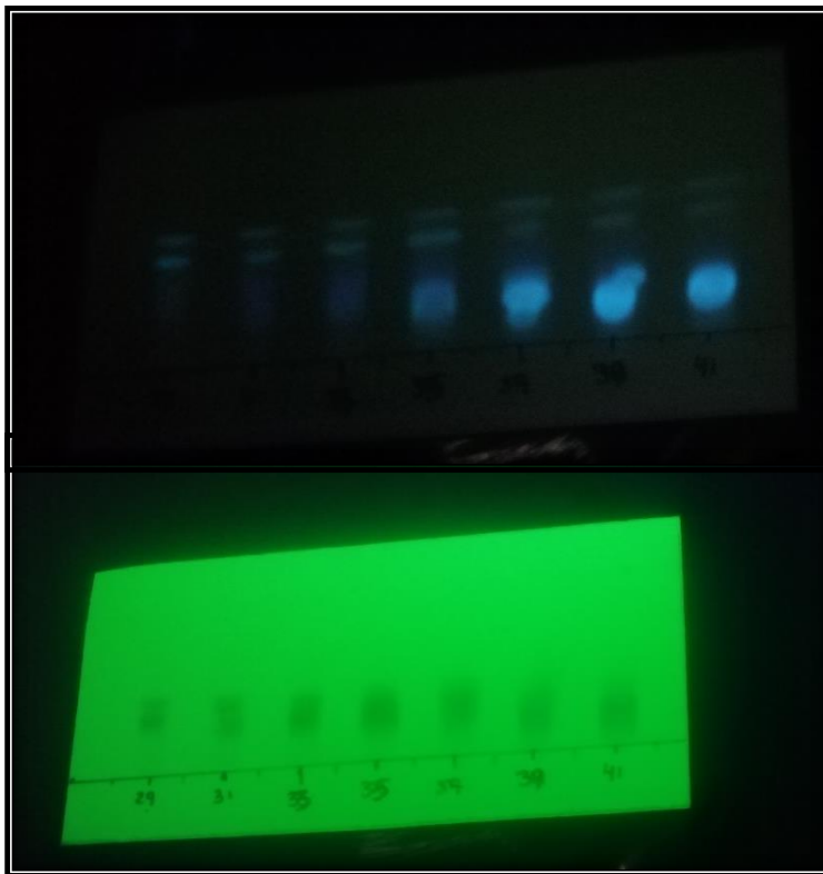
Figura 14. Placas cromatográficas de diferentes reuniones obtenidas de cromatografía capa fina.
