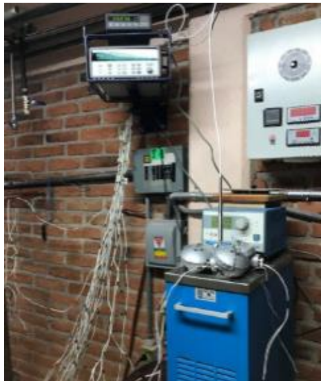
Figura 12. Calibración de los sensores de temperatura PT-1000
