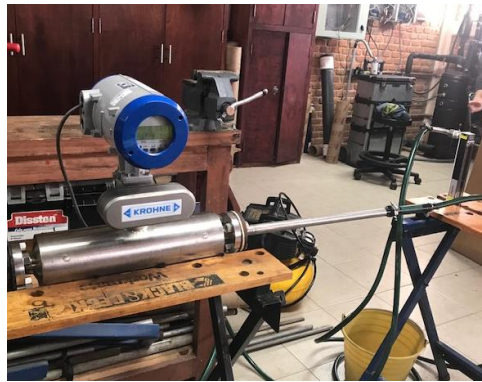
Figura 13. Proceso de calibración de los flujómetros para solución
