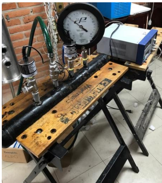
Figura 14. Proceso de calibración de los transductores de presión
