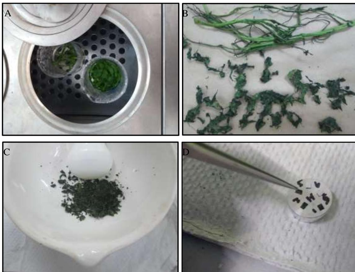
Figura 2. Procesamiento de plantas de berro para análisis nutricional, A) Muestra en Baño maría, B) Secado de la muestra, C) Macerado y D) Fijación de fibras en el portamuestras.
