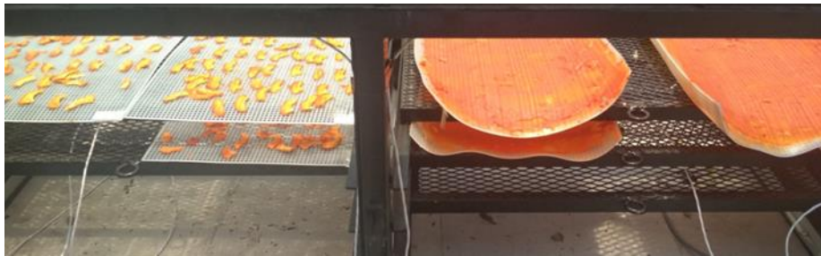
Figura 12. Secado de zapote mamey en hojuelas (izquierda) y pasta (derecha) en el secador mixto.
