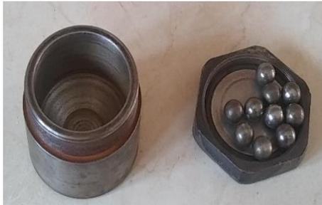
**Fig. 26** Vial y balines usados en la síntesis de la aleación
