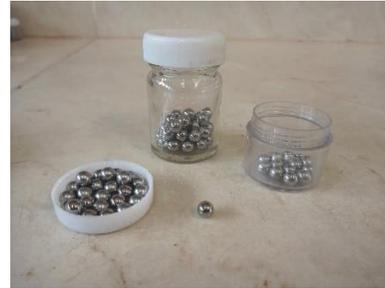
**Fig. 27** Balines usados en la aplicación del recubrimiento
