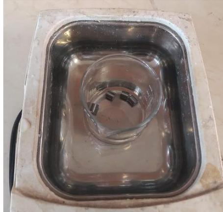
**Fig. 56** Limpieza de probetas de acero 4140
