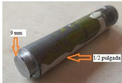
**Fig. 54** Barra de acero 4140 con diferentes diámetros
