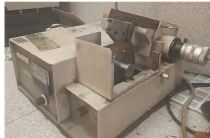
**Fig. 33** Cortadora de disco
