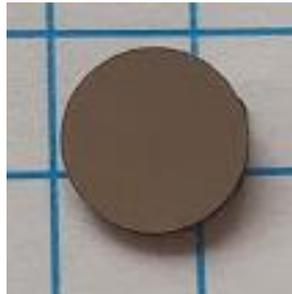
**Fig. 66** Muestra pulida a espejo
