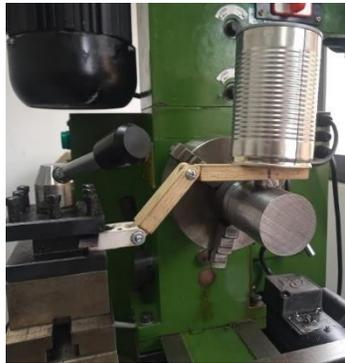
**Fig. 67** Mecanismo para pruebas de desgaste
