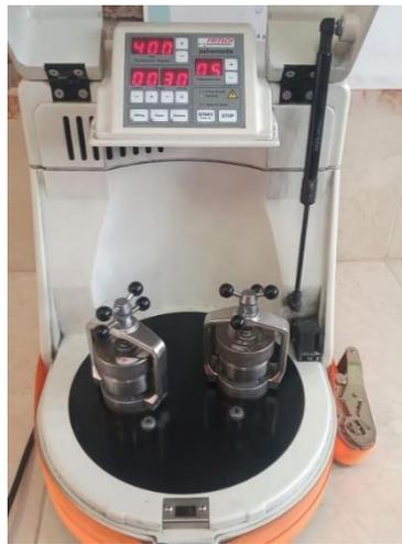
**Fig. 50** Sujeción de los viales y programación de los parámetros de molienda en el molino
