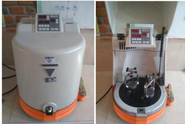
**Fig. 25** Molino planetario de baja energía marca FRITSCH
