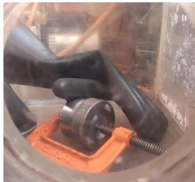
**Fig. 49** Sellado de los viales dentro de la cámara de vacío
