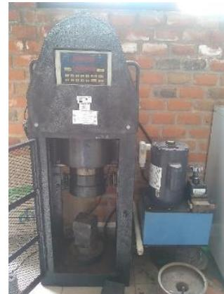
Fig. 30 Prensa hidráulica
