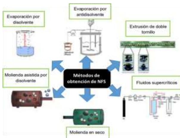
Figura 13 Representación esquemática de los métodos para la formación de cocrystal. (Karagianni, 2018)
