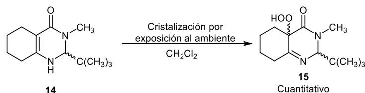
Esquema 64. Síntesis del compuesto 15.
