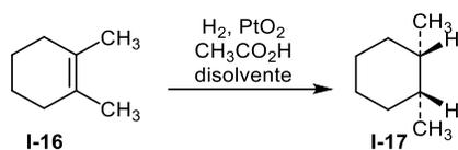
Esquema 3. Hidrogenación catalítica del 1,2-dimetil-ciclohexeno.
