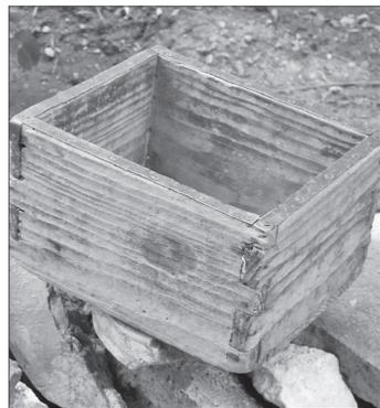
Figura 3. Maquila, instrumento de medida de volumen
