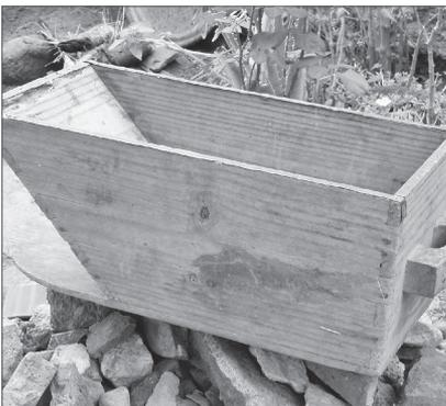
Figura 2. Decalitro, instrumento de medida de volumen
