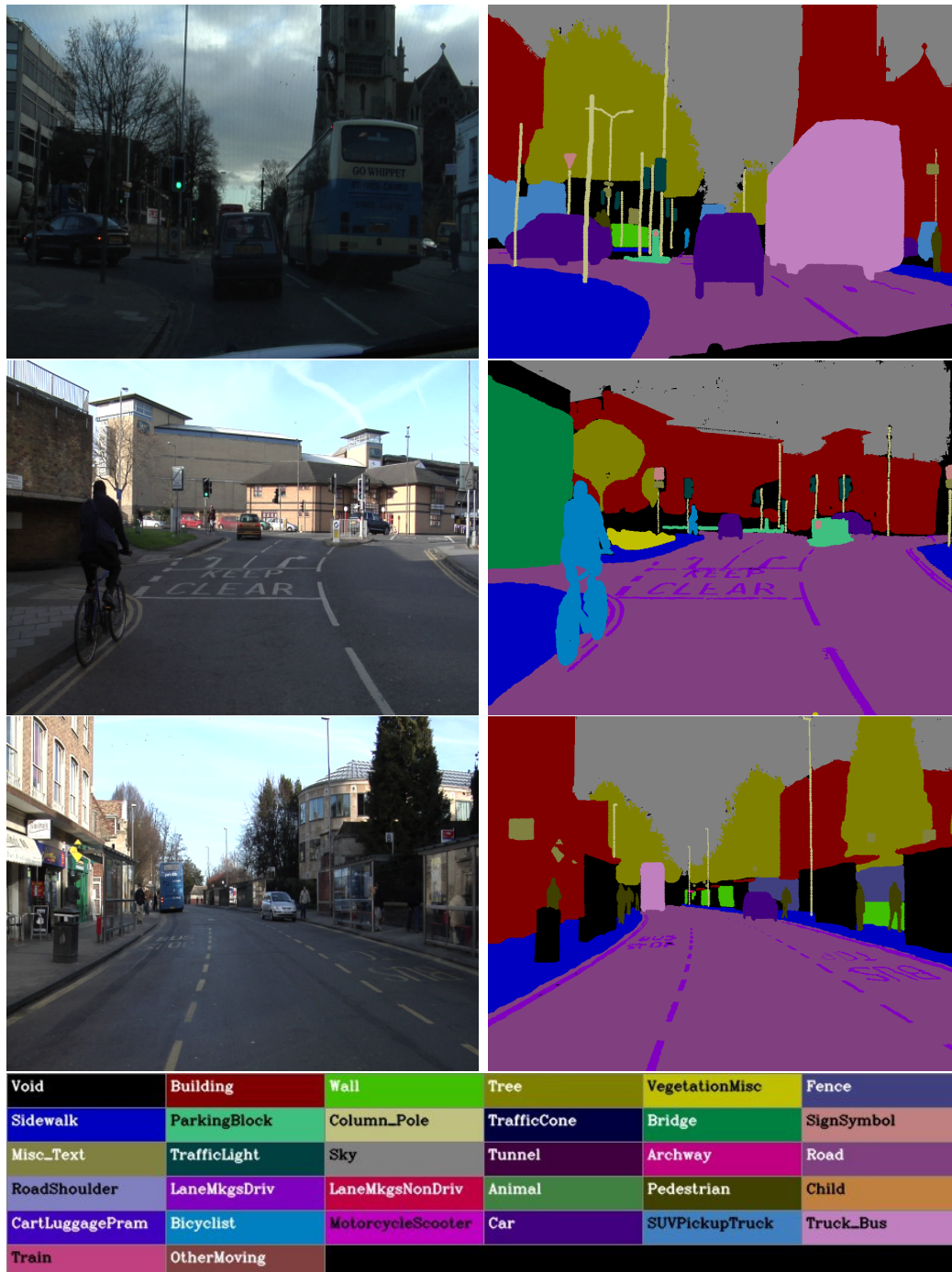
Figura 3.2: Imágenes de CamVID dataset. Columna izquierda, imágenes RGB. Columna derecha, Ground Truth . Fila de abajo, lista de colores de las clases asignadas.
